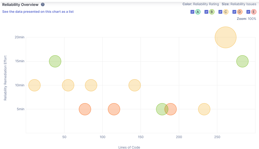
Abbildung 9: Reliability Overview der Sonar Qube Qualitäts Analyse
